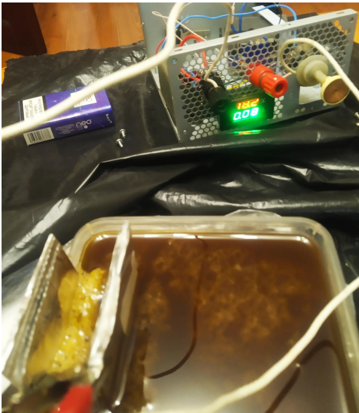
Рисунок 5 - Электролиз загрязнённой песчано-водяной пульпы без добавления пищевой соды (гидрокарбонат натрия)
