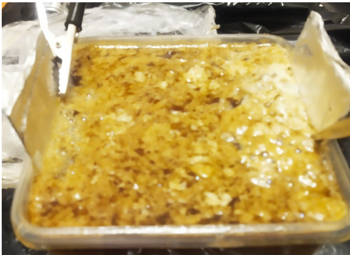
Рисунок 8 - Электролиз загрязнённой песчано-водяной пульпы с добавлением пищевой соды (гидрокарбонат натрия)
