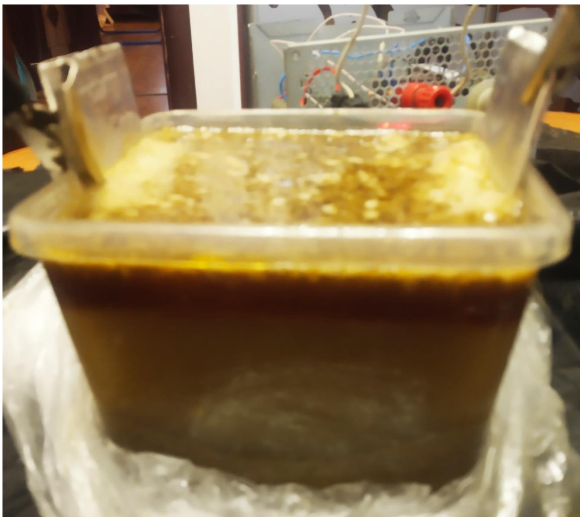
Рисунок 6 - Электролиз загрязнённой песчано-водяной пульпы с добавлением пищевой соды
