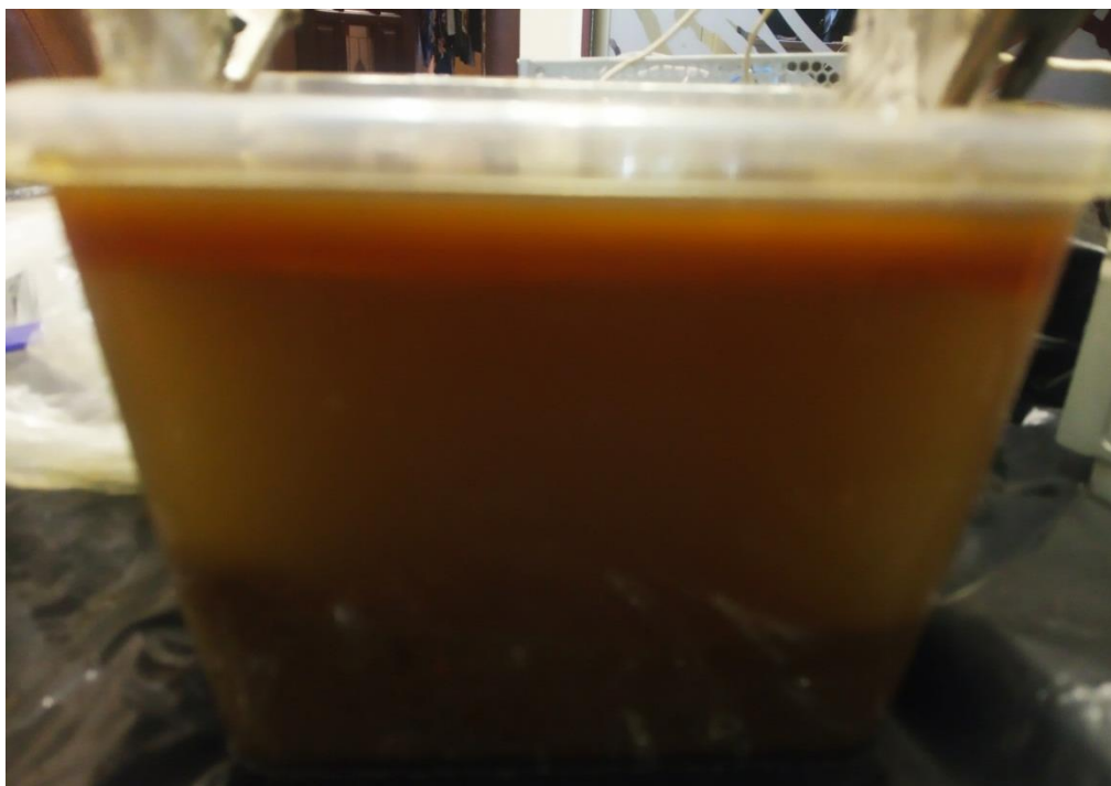
Рисунок 2 - Песчано-водяная пульпа: 330 г песок + 110 г СНП + 250 г воды, отстоянная 10 минут
