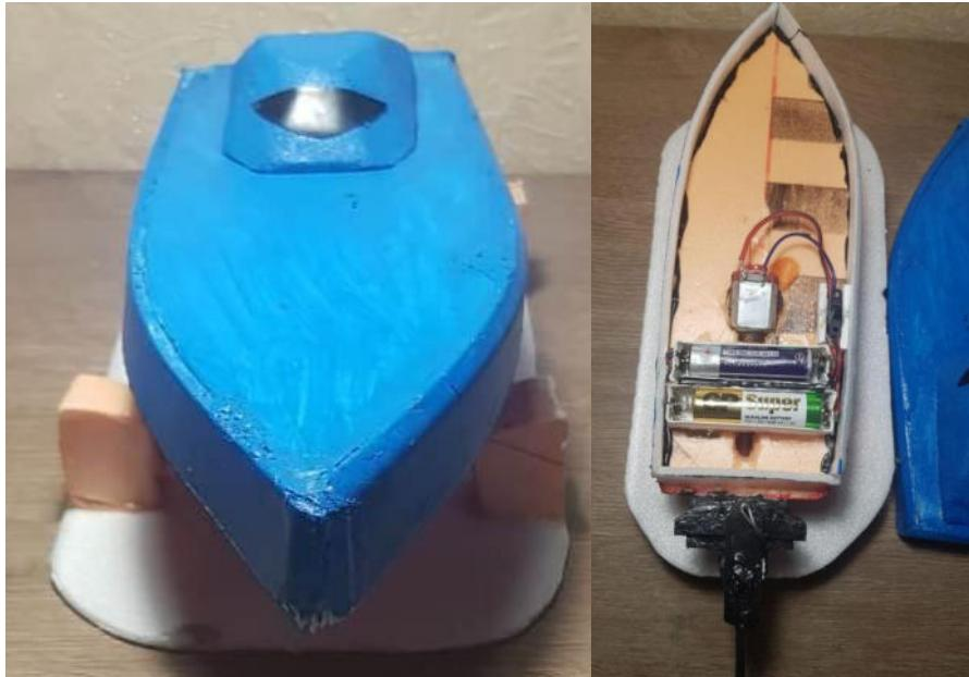
Двигатель на 3 вольта. Работает с двух батареек АА.
