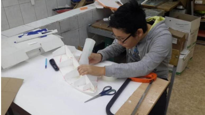
1. Этап работы – перенос шаблона на пенопласт и последующее его вырезание.
