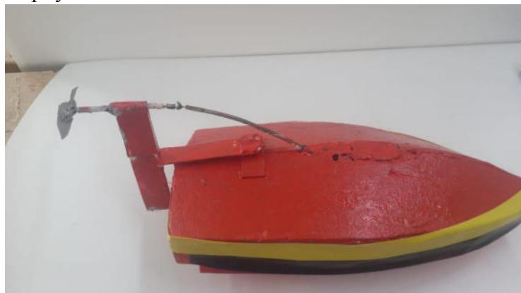
Винт и руль совмещены. Винт крутится через гибкую передачу и понижающую ременную передачу.
