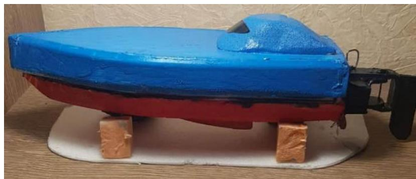
Катер прямого курса с механическим, настраиваемым рулем, которым можно выбрать направление модели.
