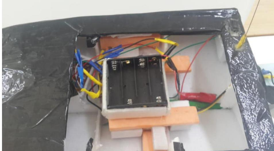
Винт крутится за счет двух спаренных через редуктор двигателей, которые крутят один большой винт. Радиоуправление на 27 МГц.
