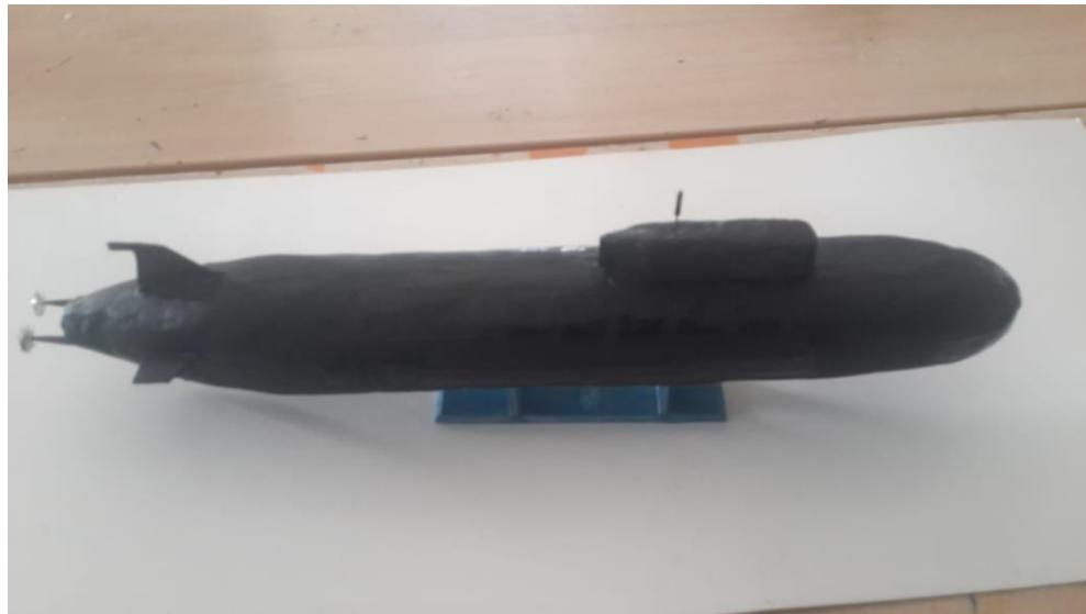
Корпус из экструдированного полистирола высокой прочности.
