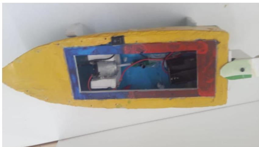
Винтомоторная группа содержит: мотор на 3 вольта, самодельный винт из жести, дейдвуд из фломастера, вал из вязальной спицы.
