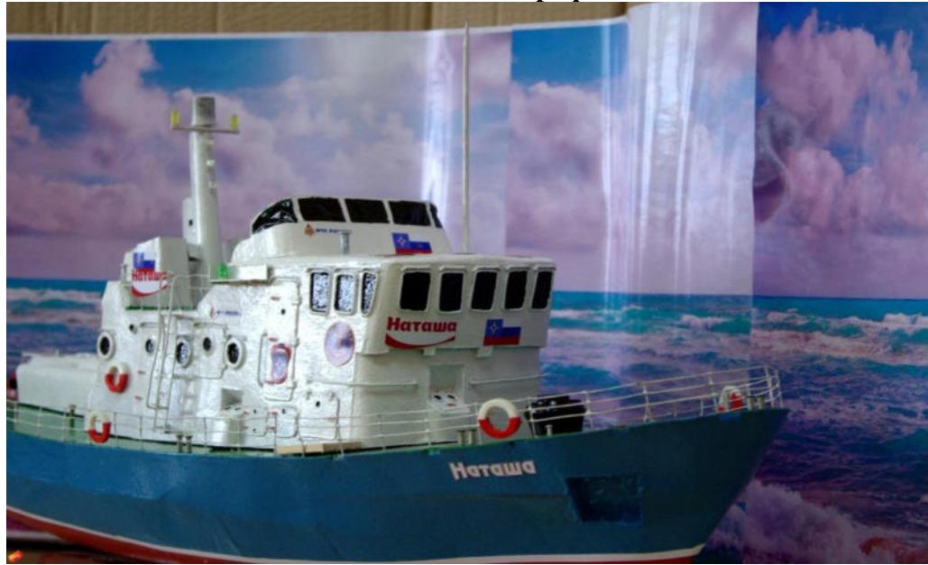
На фотографии представлена модель спасательного судна «Наташа» МЧС России. Выполнена она по технологии работы с картоном. Применялся самый обычный упаковочный картон путем пропитки эпоксидной смолой. Этим ему придавалась жесткость и водонепроницаемость. Модель изготавливалась 1,5 года. Изготовил модель Габышев Вадим ученик 7 класса воспитанник кружка «Судомодельный» руководитель Габышев А.Н.
