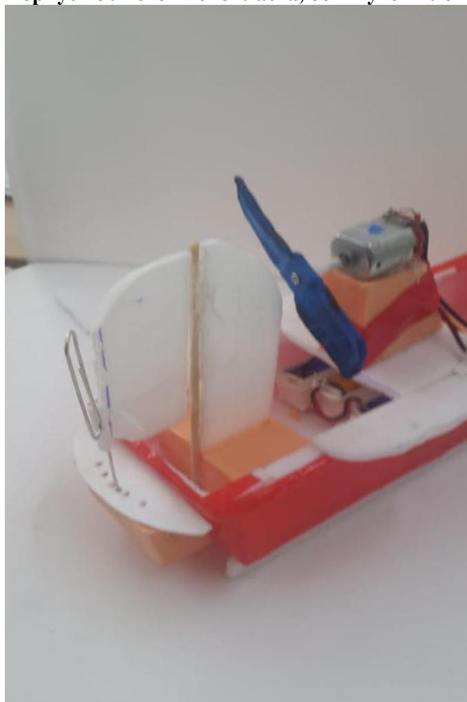
Руль сделан из пенопласта, фиксаторы из пластиковой трубочки, листового ПВХ и скрепки. Судно может менять курс по заранее настроенному рулю.
