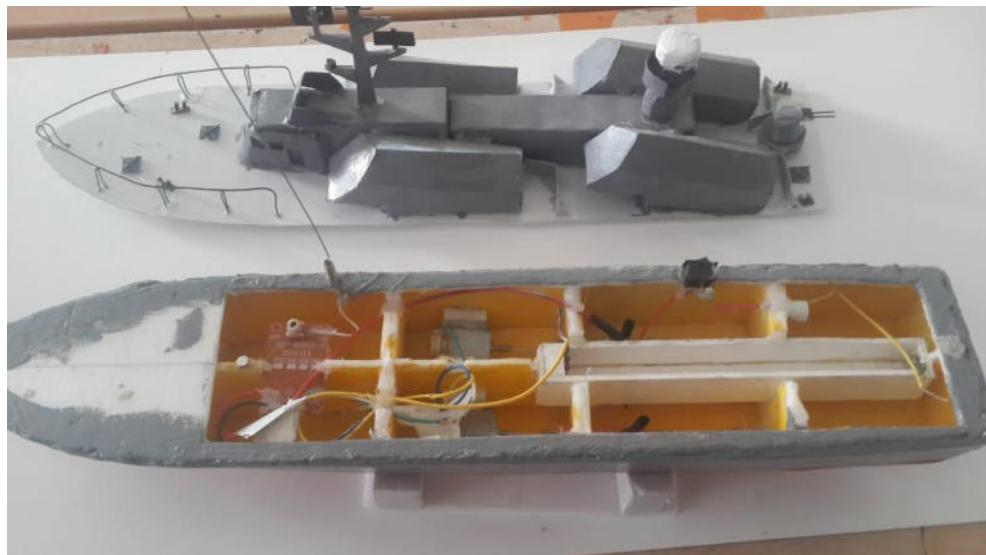
Винтомоторная группа: самодельные дейдвуды из фломастеров, винт из жести, вал из спиц.
